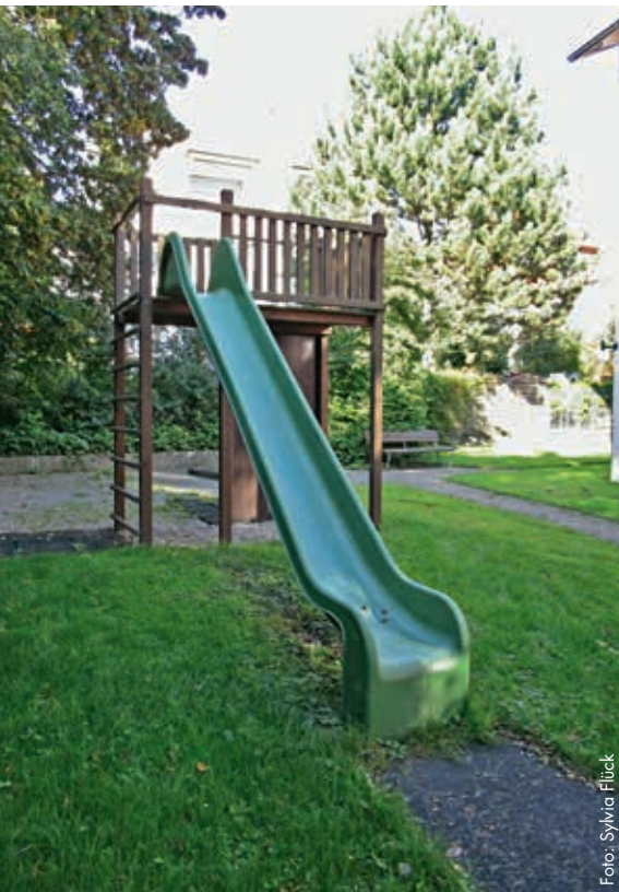
Absturzgefahr: Grosse Fallhöhe und harter Boden bei Rutsche.
